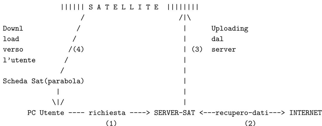
Prima di tutto facciamo la richiesta (1) (utilizzando la nostra connessione ad Internet) al Server Satellitare, che a questo punto recupererà i dati per noi da Internet (2) e li manderà al Satellite (3); infine noi riceveremo i dati direttamente dal Satellite (4) a casa utilizzando l'antenna parabolica connessa alla Scheda Sat.
