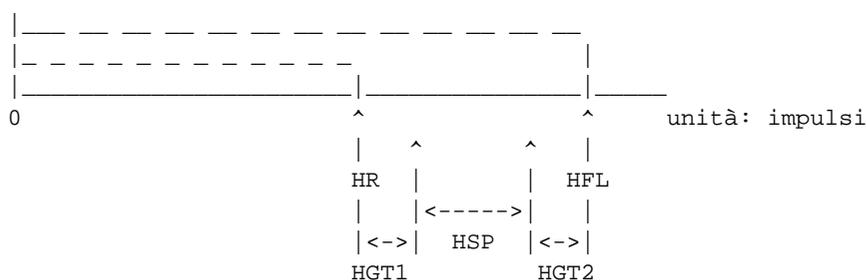
Ora, noi vorremmo piazzare un impulso di sincronismo di lunghezza HSP come mostrato sopra, ad esempio, fra la fine degli impulsi di clock per mostrare dati e la fine degli impulsi di clock per l'intero quadro. Perché così? Perché se possiamo ottenere ciò, allora l'immagine sullo schermo non si sposterà a destra o a sinistra. L'immagine sarà dove dovrebbe essere sullo schermo, coprendo all'incirca tutta l'area visibile del monitor.
