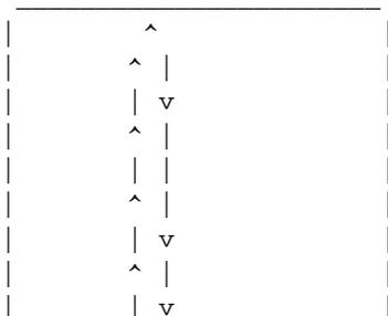
La frequenza di sincronismo verticale è il numero di volte al secondo al quale il pennello elettronico del monitor può tracciare un disegno tipo questo
