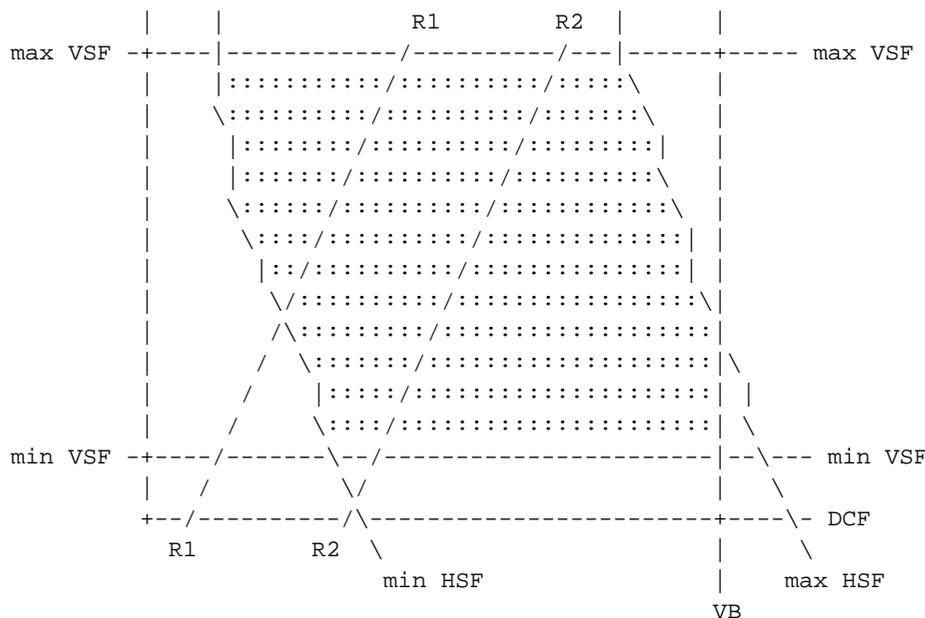
Questo è un diagramma di modalità di un monitor generico. L'asse x del diagramma mostra la frequenza del clock (DCF), l'asse y rappresenta la frequenza di refresh (RR). La regione riempita del diagramma descrive le capacità del monitor: ogni punto entro questa regione è una possibile modalità video.
