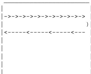
La frequenza di sincronismo orizzontale è il numero di volte al secondo al quale il pennello elettronico e del monitor può tracciare un disegno tipo questo
